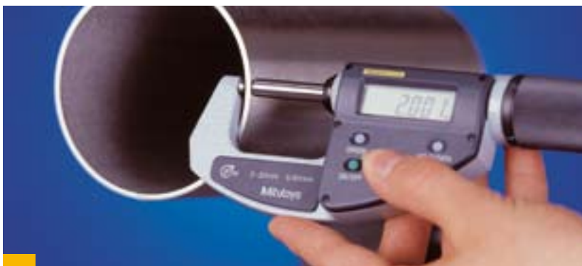
Messung der Wanddicke
