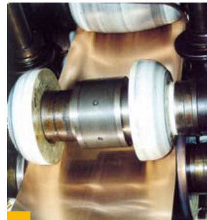
Bild 16: Kontinuierliches Einformen des Bandes durch Kaltumformung
