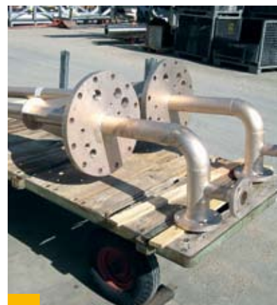
Bild 20: Verarbeitung von Rohrzubehör zu Rohrsystemen für die Brunnentech. aus einer Kupfer-Nickellegierung
