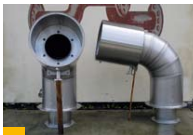
Bild 32: Seewassergekühlte Abgaskrümmer für ein Schadstoffunfallbekämpfungsschiff (SUBS) aus Werkstoff-Nr. 1.4565
