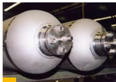
Bild 24: Druckbehälter aus 1.4565 für den Einbau in U-Booten
