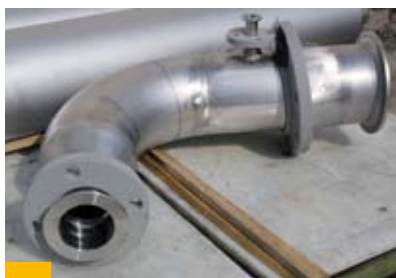
Bild 18: Vorgefertigtes Rohrleitungsteil für die petrochemische Industrie aus Werkstoff-Nr. 2.4819/Alloy C276
