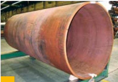
Bild 9: Schlitzrohr mit Nahtvorbereitung aus Werkstoff SF-CU (CU 75) in der Abmessung 1451 × 35 mm
