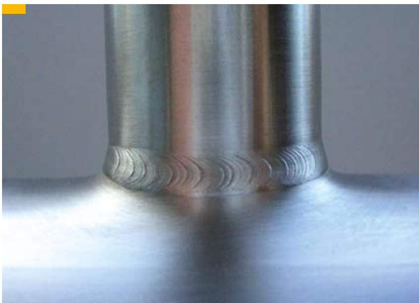
Bild 14: Orbitalschweißnaht mit ausgezeichneter Schweißnahtgüte
