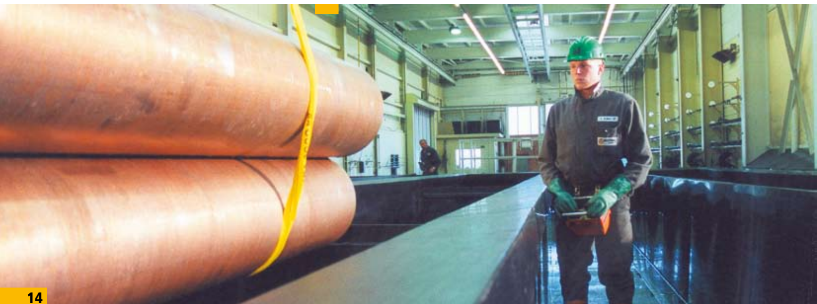
Bild 26: Rohre einer Kupfer-Nickellegierung werden in eine werkstoffspezifische Beize getaucht
