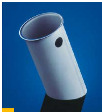
Bild 23: Verschleißschutzhülse im Abgaskrümmen von Großdieselmotoren aus Werkstoff 2.4856 (Inconel 625)
