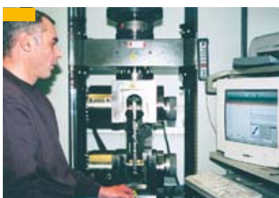
Bild 27: Burkhard Hirtz beim Zugversuch mit Feindehnungsmessung
