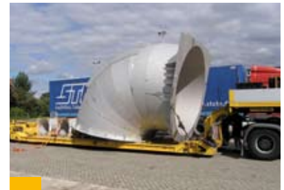
Bild 39: Schwertransport eines Segmentbogen für ein Hochwasserrückhaltebecken
