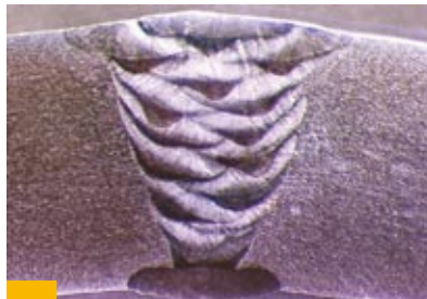
Schliff einer MAG-Schweißnaht (dickwandig)
