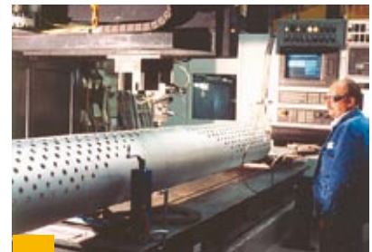
Mit moderner Technik erzeugte Laser-ausschnitte für Filterrohre
