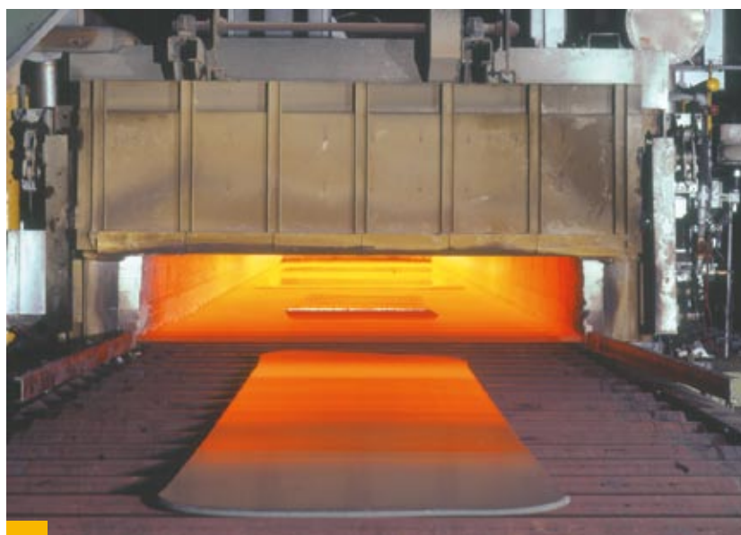
Rollenherdöfen bei ThyssenKrupp VDM, Standort in Siegen
