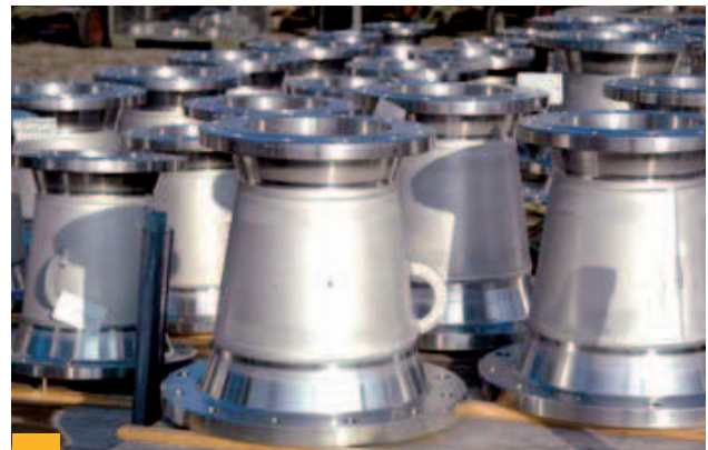
Abb: 4.2.2_2: Einbaufertigte Anschlussendstücke für einen Chemikaliertanker
